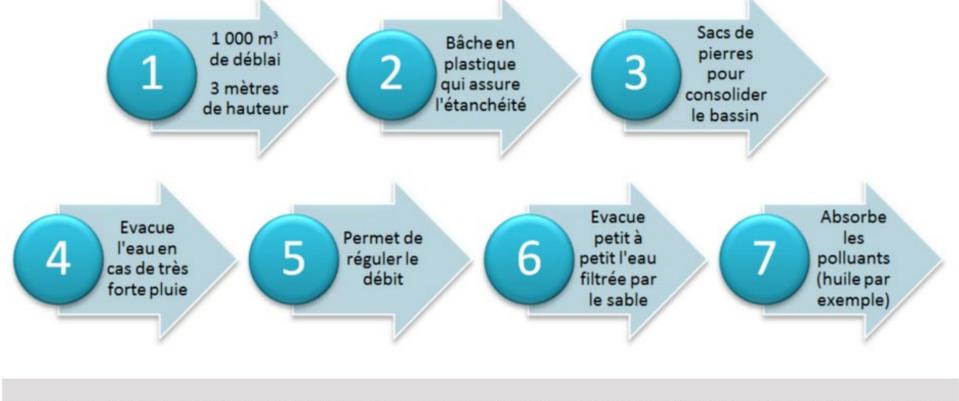
Ce bassin de rétention sert à recueillir les eaux de la **future plateforme du bus-tram**. Elles seront reconnectées au réseau d'eaux pluviales dès sa mise en service hydraulique prévue l'été 2016. Prochainement, des clôtures seront posées ; et un aménagement paysager viendra l'habiller en 2017.
