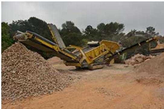
Concassage et criblage de la roche
