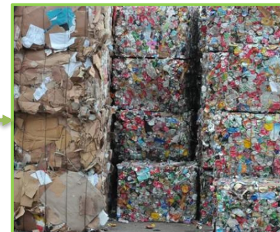
MISE EN BALLE PAR MATIÈRE POUR RECYCLAGE
