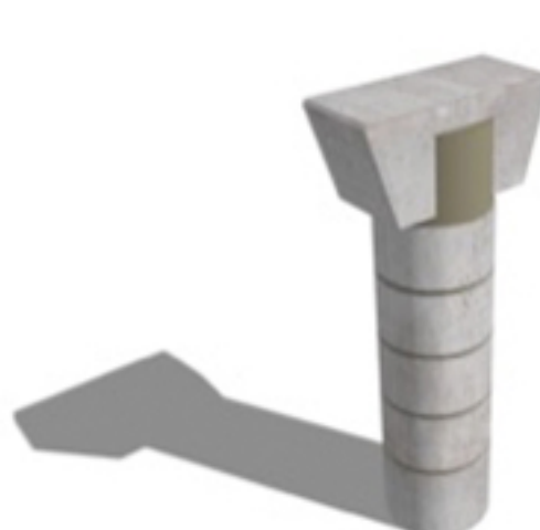
Pile du pont
